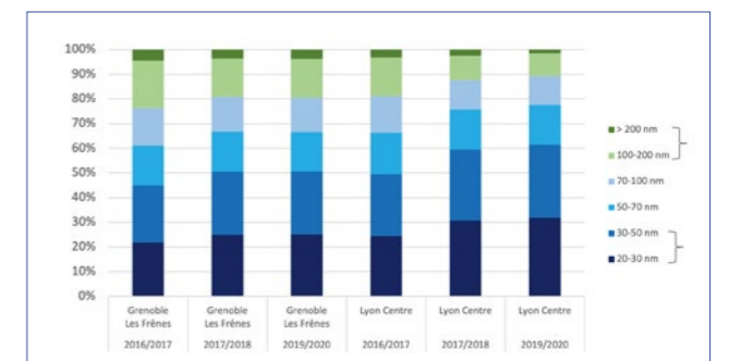
Figure 2 : Contribution des classes de taille de PUF en fonction des sites de mesures
